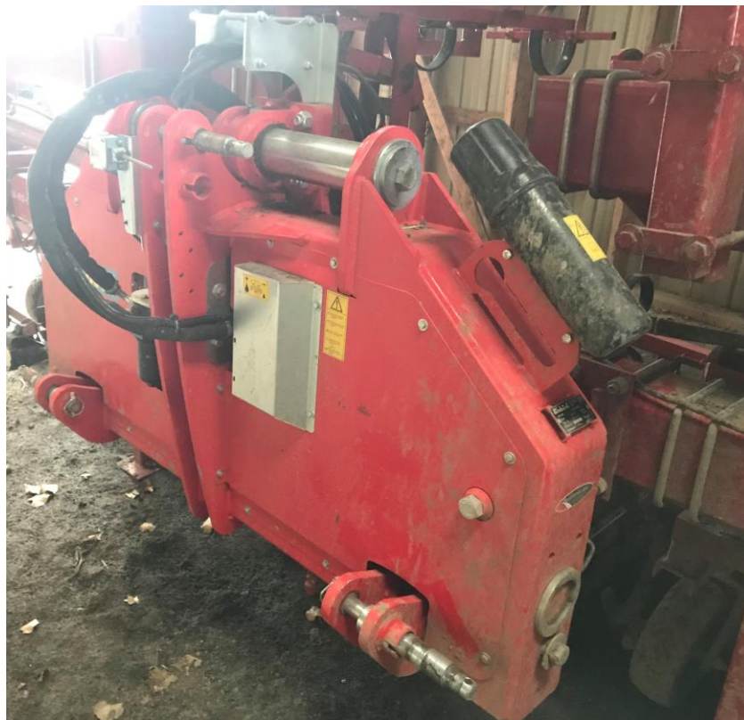
Figure 1. Le système de déplacement latéral du sarcleur (photo : Tristan Généreux)
