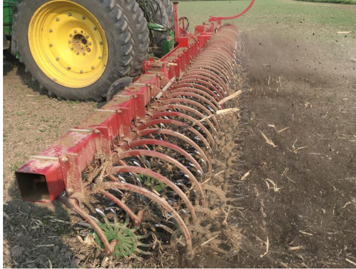
Figure 3. Houe simple conçue pour travailler dans des résidus; les roues en étoile sont beaucoup plus décalées longitudinalement les unes par rapport aux autres
