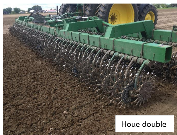
Figure 1. Détail des bras de support, ressorts et roues étoilées
