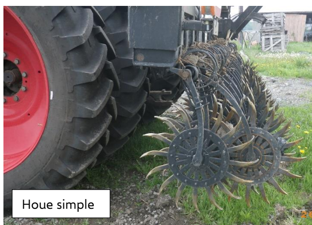
Figure 1. Détail des bras de support, ressorts et roues étoilées
