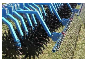
Herse étrille escamotable et réglable en agressivité
