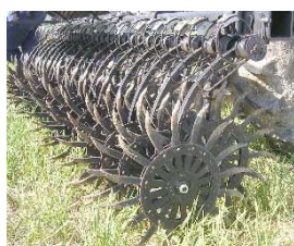
Montage une étoile par bras sur une poutre
