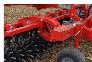
Réglage hydraulique de la pression exercée sur les étoiles
