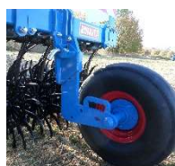
Roue avec réglage en hauteur
