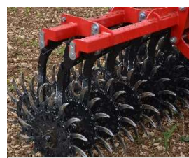
Montage 1 roue par bras sur 2 poutres
