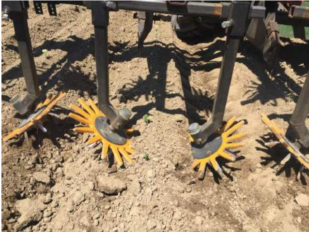
Figure 8. Petit buttage réalisé par les de doigts sarcleurs dans un sol léger; le maïs est au stade 2 feuilles
