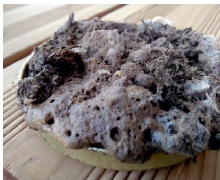
Test du carbone labile - formation de mousse et nombreuses bulles ©Stéphanie Flores
