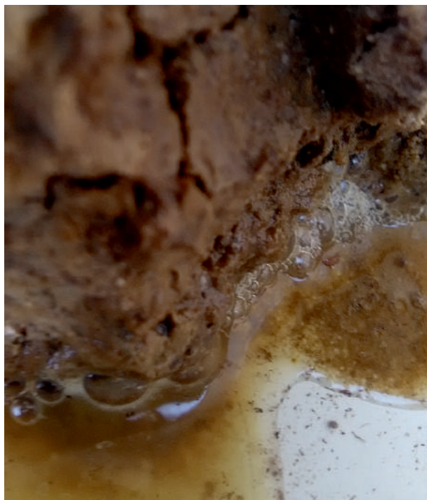
pas de réaction à l'HCl - ©Stéphanie Flores
